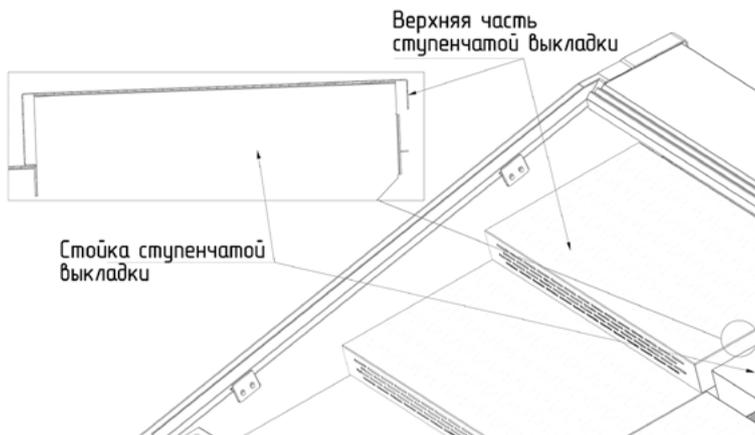
3.13.4. Собранный конструкцию ступенчатой выкладки прижмите к задней части витрины.
