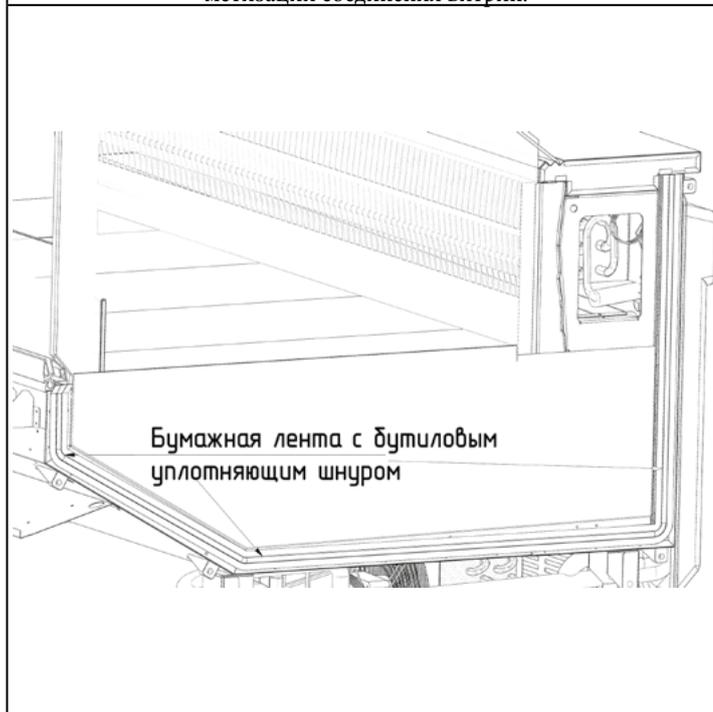
3.6.4. Установите витрины так, чтобы монтажные отверстия находились на одной оси.
