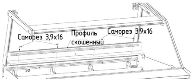
3.9.4. Открутите винты M4x10 и гайки M4, которые соединяют камеру хранения продукции и заглушку испарителя. Отклейте бумажную ленту, оставив на корпусе витрины бутиловый уплотнительный шнур, который предназначен для герметизации соединения витрин.
